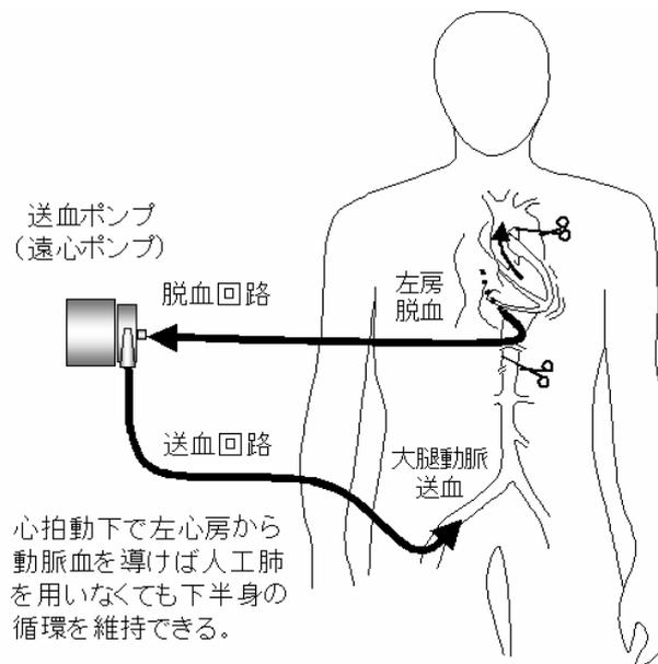
図 3-7 下行大動脈手術の左心バイパス体外循環システム
