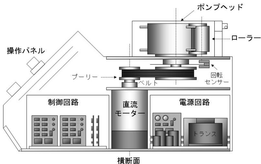
図3-2 ローラーポンプの構造
