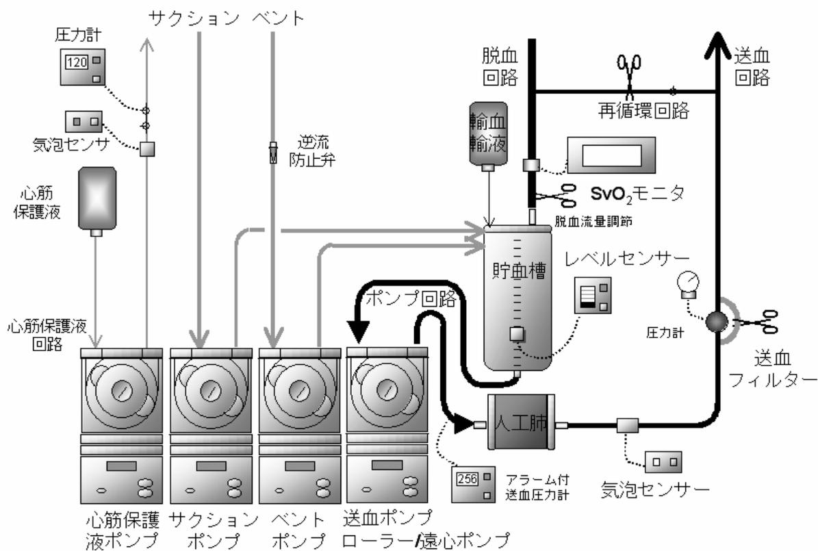
図 3-1 人工心肺装置構成図
