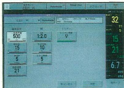
設定変更したいパラメータを選択（白く反転させる）、ロータリーノブを回し、設定を行います。設定後、決定を押します。
