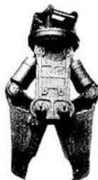
Figura 4-1 Herramienta de corte de marco de acero
