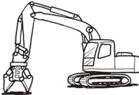
② Limpie el barro, etc., que pueda haberse adherido a la herramienta de corte de marco de acero y verifique si hay fugas de aceite, pernos sueltos, cortadores astillados o desgastados o cualquier otra anomalía.
