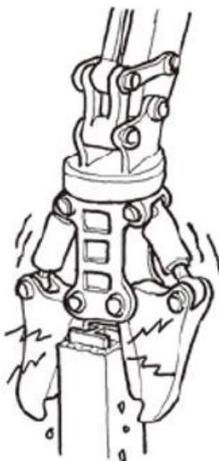
⑮ No cambie la dirección de la máquina base empujando la herramienta de corte de marco de acero contra el suelo. No haga esto, ya que no solo dañará la herramienta de corte de marco de acero y la máquina base, sino que también hará que la máquina base quede inestable.
