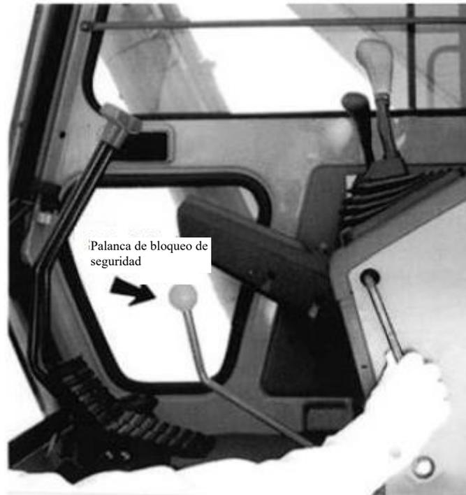
Figura 3-5 Ejemplo de palanca de bloqueo de seguridad
