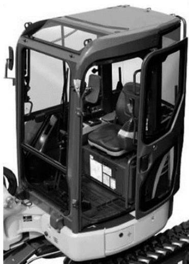
Figura 3-9 Maquinaria de construcción tipo vehicular con una estructura de protección antivuelco
