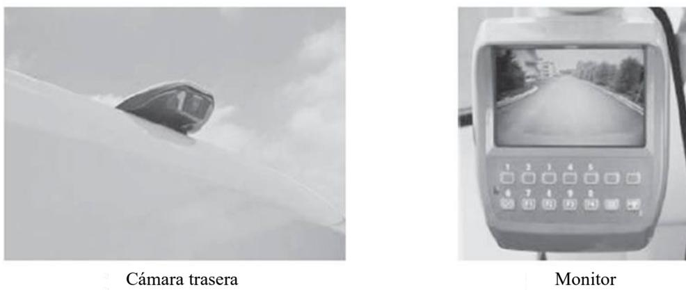
Figura 3-6 Ejemplo de monitor de vista trasera
