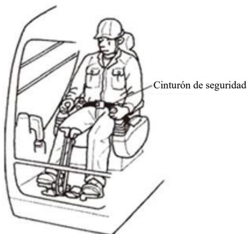
Figura 3-18 Ejemplo de uso de un cinturón de seguridad
