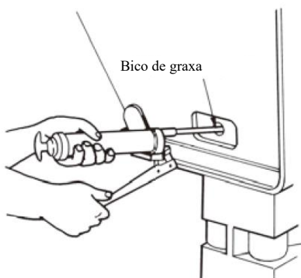
Fig. 5-3 Exemplo de engraxamento com uma pistola de graxa
