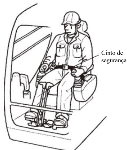
Fig. 3-18 Exemplo de uso de cintos de segurança
