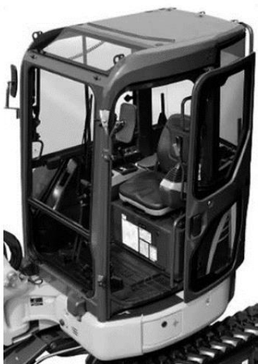
Foto 3-9 Máquina de construção do tipo veicular com uma estrutura de proteção contra quedas
