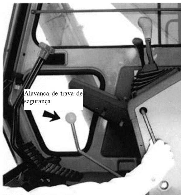
Foto 3-5 Exemplo de alavanca de trava de segurança
