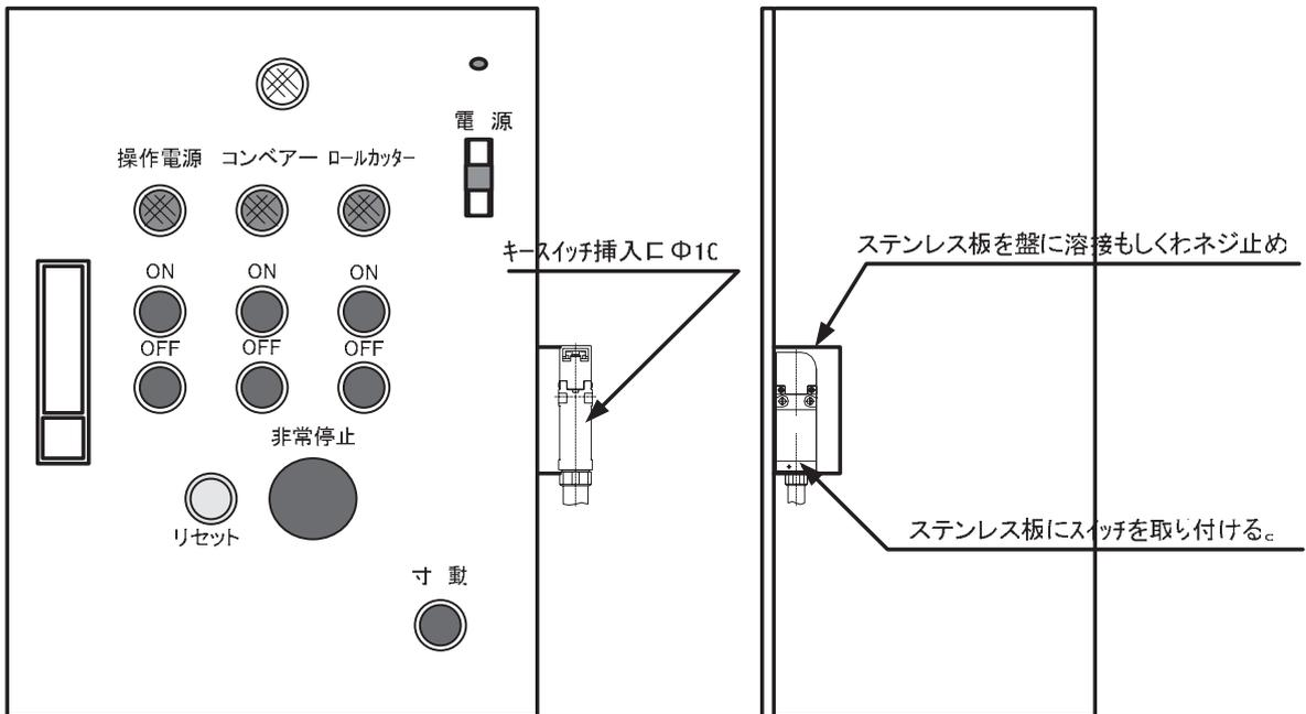
\*1 盤内に取付けが不可能（盤内のスペースが無い）場合は側面に設置する。
