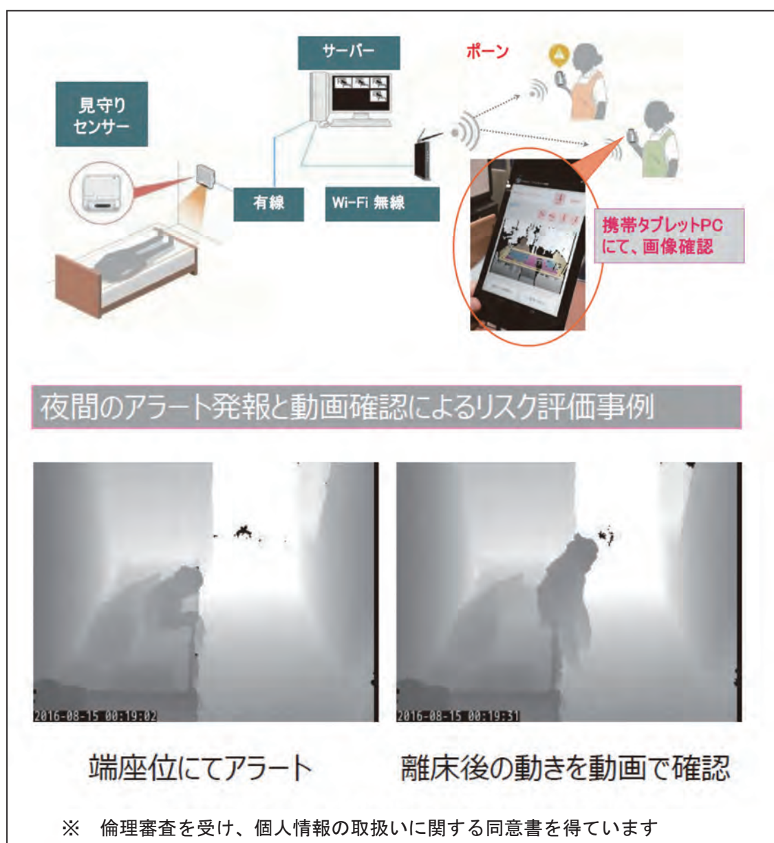
図表5-6 赤外線距離センサーを用いた居室見守りシステム
