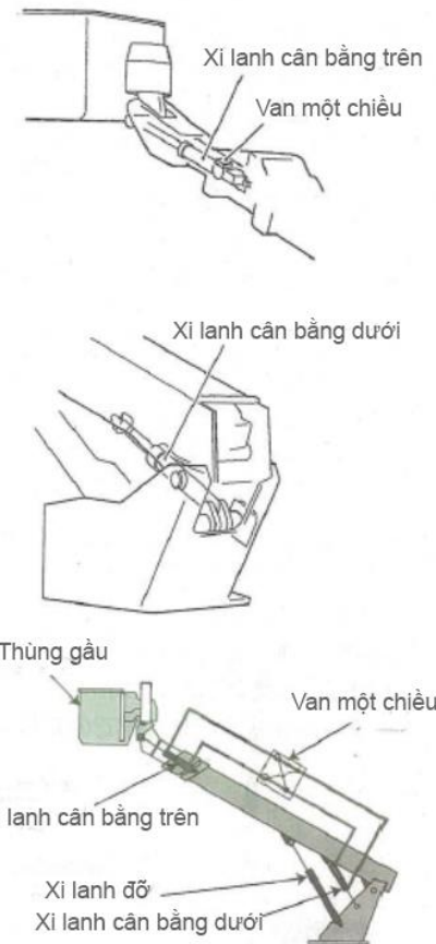
Hình 2 - 8 Ví dụ về thiết bị xi lanh cân bằng
