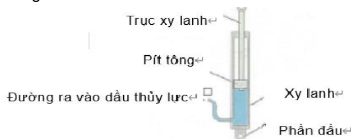
Hình 3-17 Xy lanh kiểu đơn động
