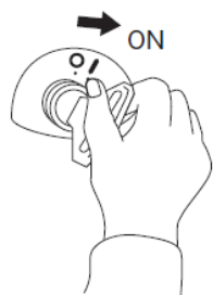
Hình 2-34 Khởi động loại động cơ dùng dầu diesel (1)
