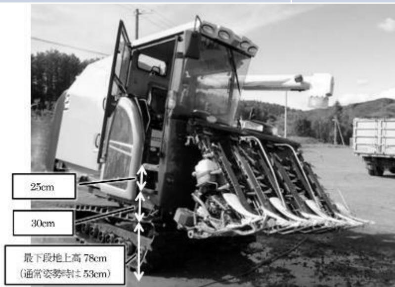
図1 事故機の外観とステップ間隔（車体右側を上げた状態での数値。被災時は全体が上がっていた）
