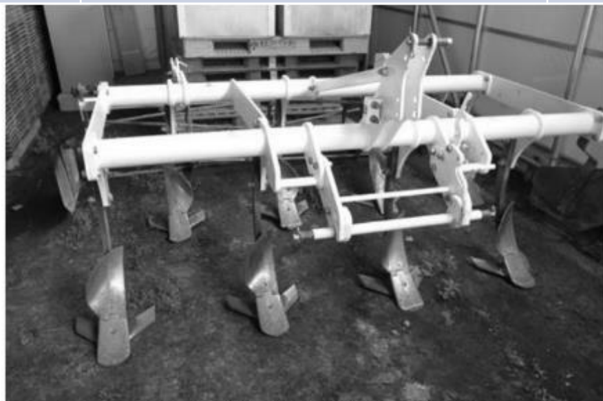
図2 事故当時、使用していたスタブルカルチ 全長2180mm、全幅2730mm、全高1170mm、機体質量550kg
