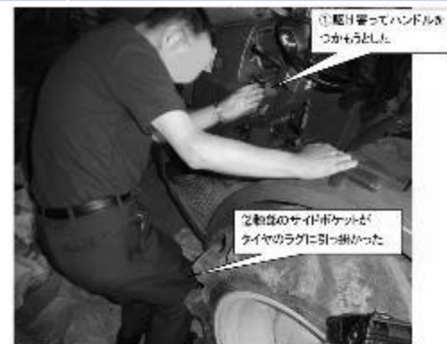
図3 転倒時の様子（機体） （写真のトラクタは事故直後直前に導入したもの）
