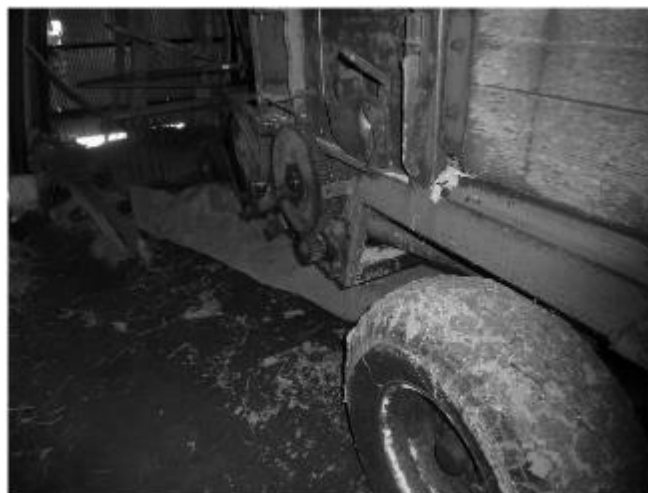
図2 被災者が負傷したギヤがある部位 (機体左後方にある)
