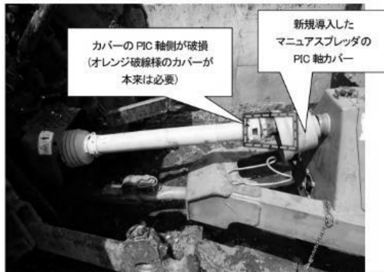
図2 トラクタからトレーラ側油圧ポンプを駆動していたユニバーサルジョイント
