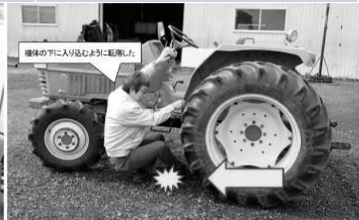
図4 転落して左後輪にひかれる直前のイメージ
