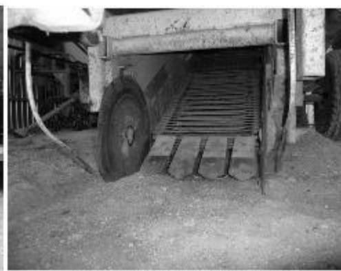
図3 駆動軸と拾い上げコンベアを横方から見た様子
