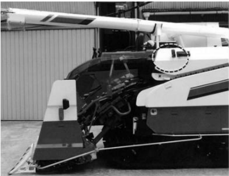
図2 事故機と同型機の手こぎ部 (平成11年度以降、点線部に緊急停止ボタンが装備されることになった)
