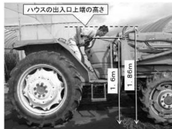
図4 トラクタとハウス出入口上端の高さの寸法関係
