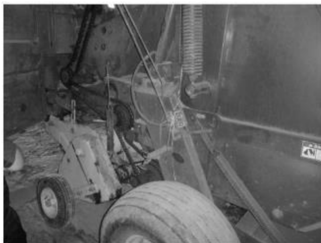
図2 被災者がグリスを塗ろうとしていたチェーン部分（機体右側のカバー内）
