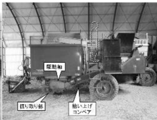
図2 事故機の構造の様子 1名乗用作業台車両の共同作業者立ち位置
