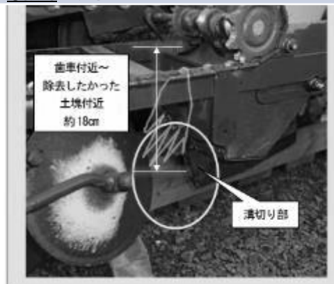
図5 被災時の姿勢及び手元の再現（黄色枠部に溜まった土を除去しようとした）
