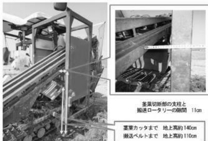
図3 被災者が手を入れてしまった隙間の概寸
