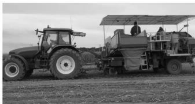
図1 ポテトハーベスタの作業風景 (トラクタにけん引されたポテトハーベスタに補助作業者3～6人が乗って選別作業を行う)
