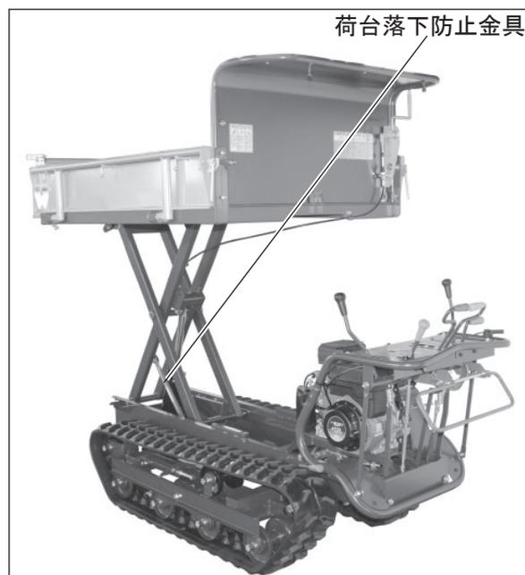
ダンプ時の荷台落下防止金具のセットのしかた
