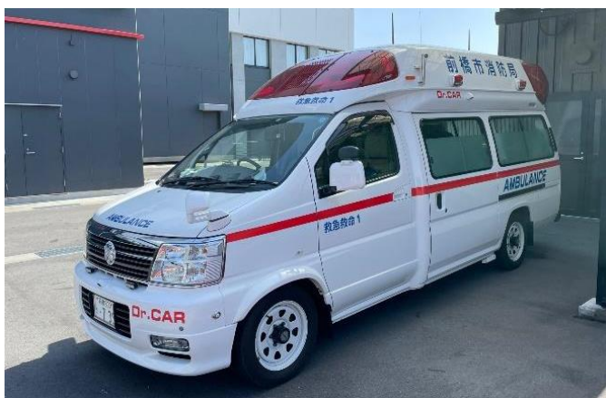
写真 2A-3 患者搬送機能を有するワークステーション方式ドクターカー（前橋赤十字病院）
