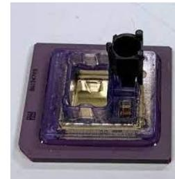
図：鋳型調整キットとフローセルの外観
