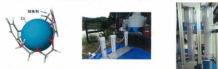
図 6：クラウンエーテル捕集材によるセシウム吸着構造（左）とセシウム除去処理装置（中：プレフィルター、右：トルネード吸着塔）
