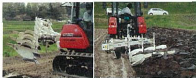
図1：ジョインター付きプラウ（耕深 30cm、トラクタ牽引）：本宮市、5月9日実施
