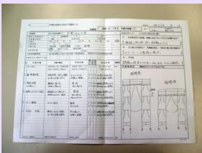
現場(G)で作る作業手順書(T) GTは小さな作業でも油断せず、 確実に安全対策を講ずるためのもの
