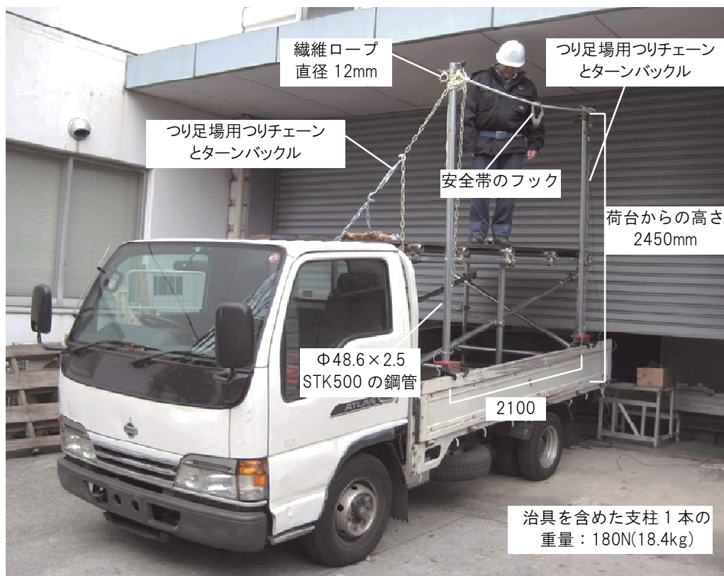
図 3-15 トラック積載型の安全带取付設備に安全带をかけた状態
