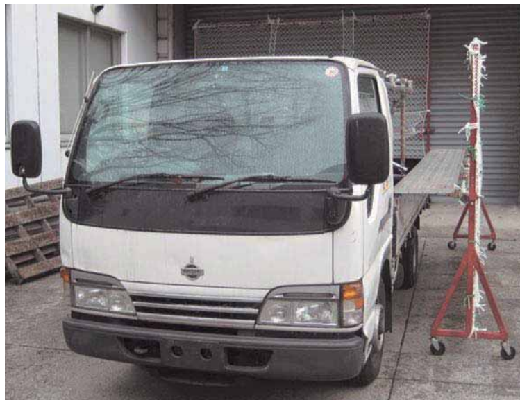
図 3-8 据置型作業床をあおりに取り付けた状態
