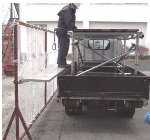
図 3-10 あおりに取り付けた据置型作業床の上を作業員が移動している様子
