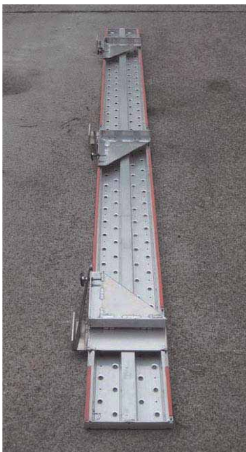
図 3-3 トラック積載型の作業床を取り出した状態 (作業床の支えのブラケットは折りたたんだ状態)
