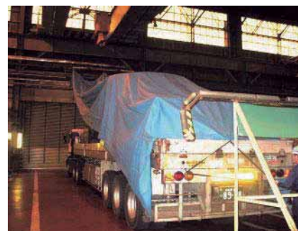
図 4-15 シート掛け完了寸前の状態
