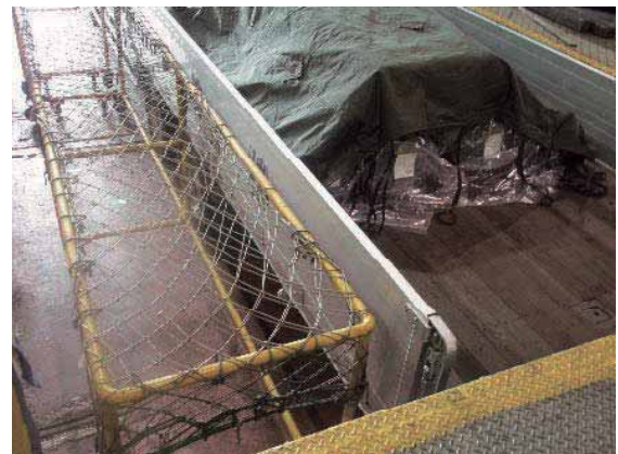
図 4-20 墜落防止用補助架台 (キャスターにより移動可能)
