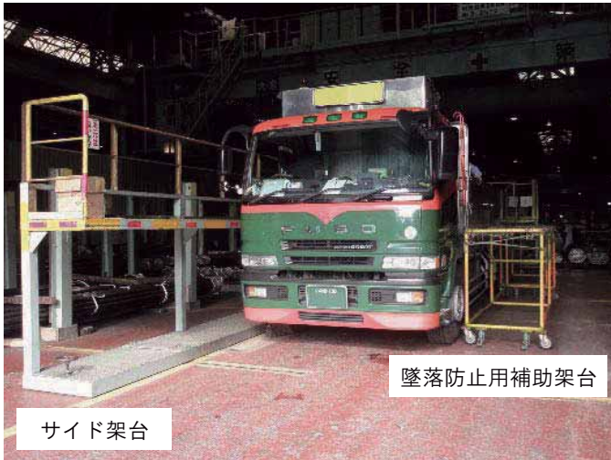
図 4-21 架台セット完了
