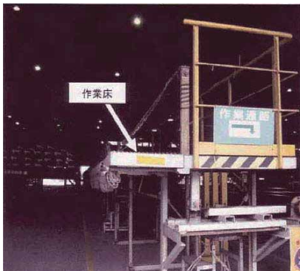
図 4-27 作業床を使用
