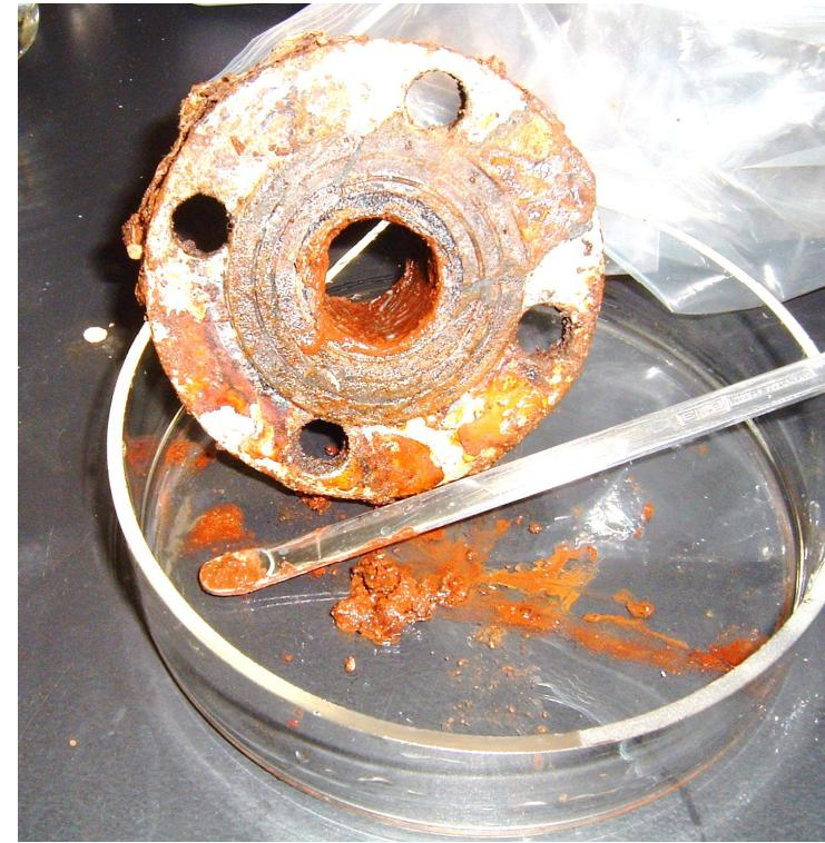
ポリエチレンライニング管のひび割れによる鉄さび
