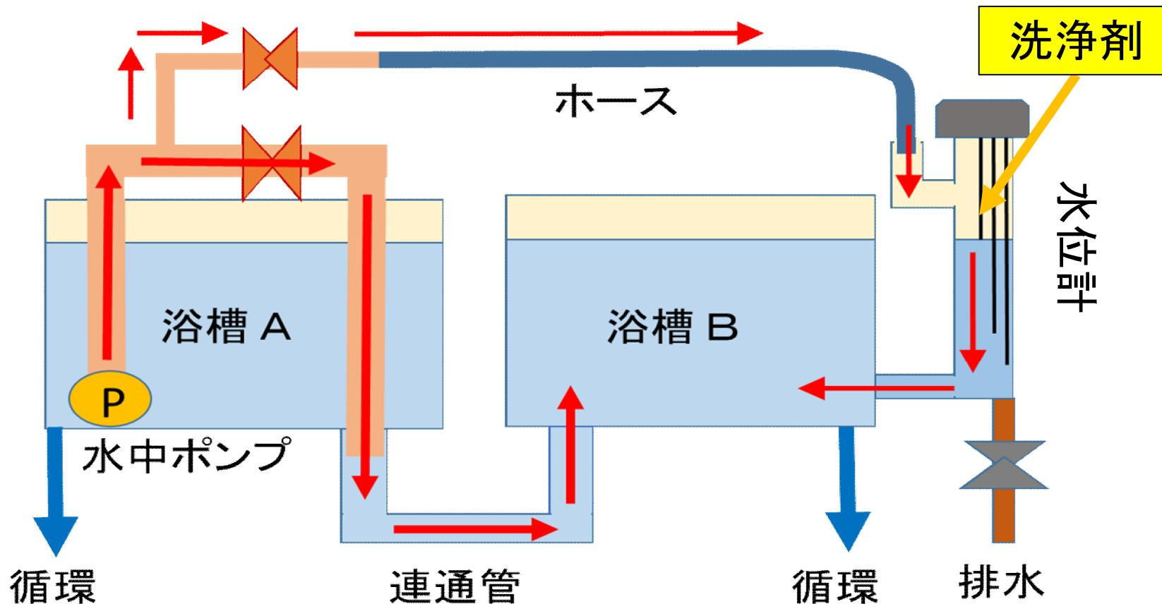
浴槽に水中ポンプを入れ、洗浄液（高濃度塩素水）を連通管、水位計配管に流し込み循環させる
