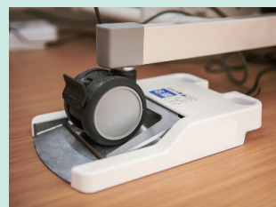
PCでの表示・通知（上）とベッド脚へのセンサ設置（右）イメージ
