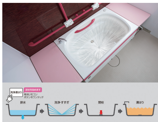
図1 自動洗浄・湯はり浴槽(上)と運転イメージ
