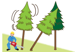
(図4)かかり木に激突させるためにかかり木以外の立木の伐倒
