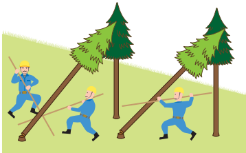
(図2)かかり木の処理
