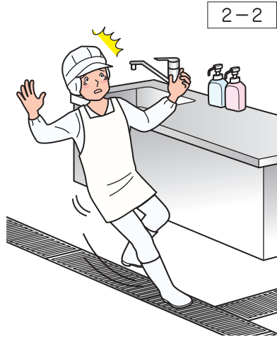
グレーチングで、転倒の危険
