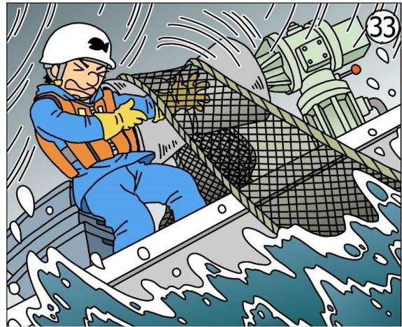
**事故例 2：** ネットホーラーを使用して揚網作業中、荒天で船のローリングが激しく、体のバランスを崩した時に合羽の袖口がはさまれ左手及び腕部をネットホーラーにはさまれた。<sup>③</sup>
