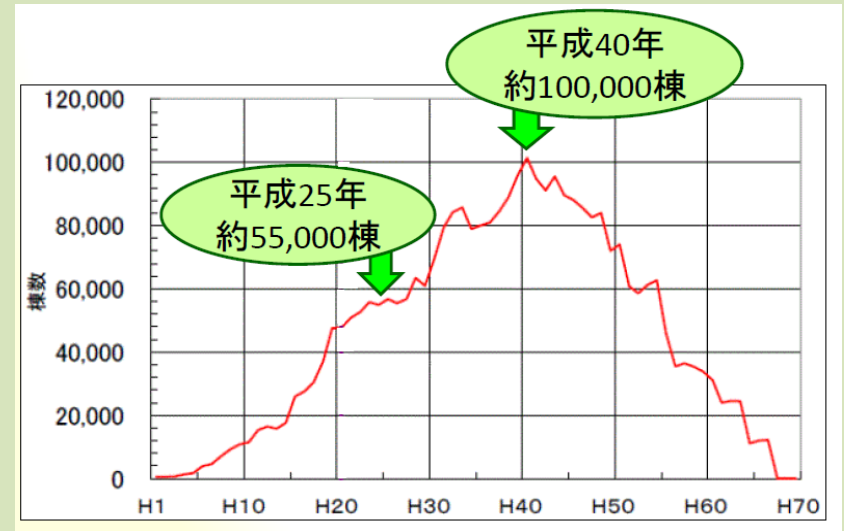
民間建築物の年度別解体棟数（推計）
