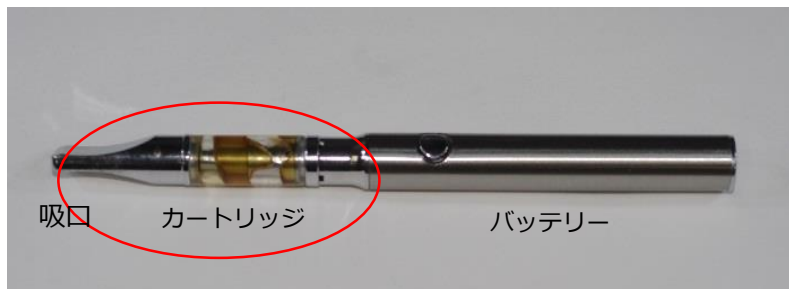
【図2】 カートリッジを装着した電子タバコ
