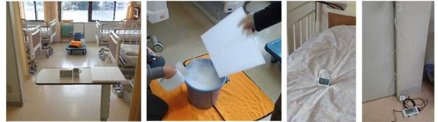
CO<sub>2</sub>発生・濃度測定のための準備 ドライアイスによるCO<sub>2</sub>発生 CO<sub>2</sub>濃度計 差圧計
